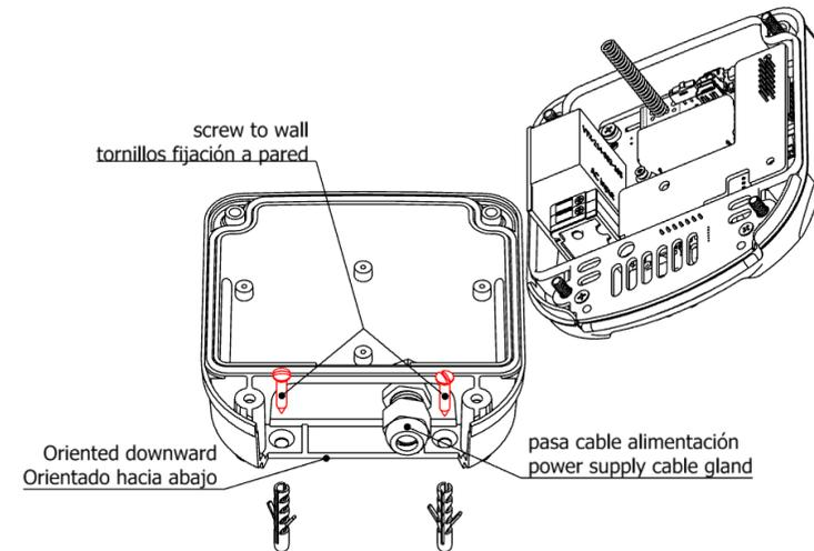
Nota instalación: Evitar instalar junto a fuentes de calor / corrientes de aire / radiación directa del sol, podría afectar a las medidas.
